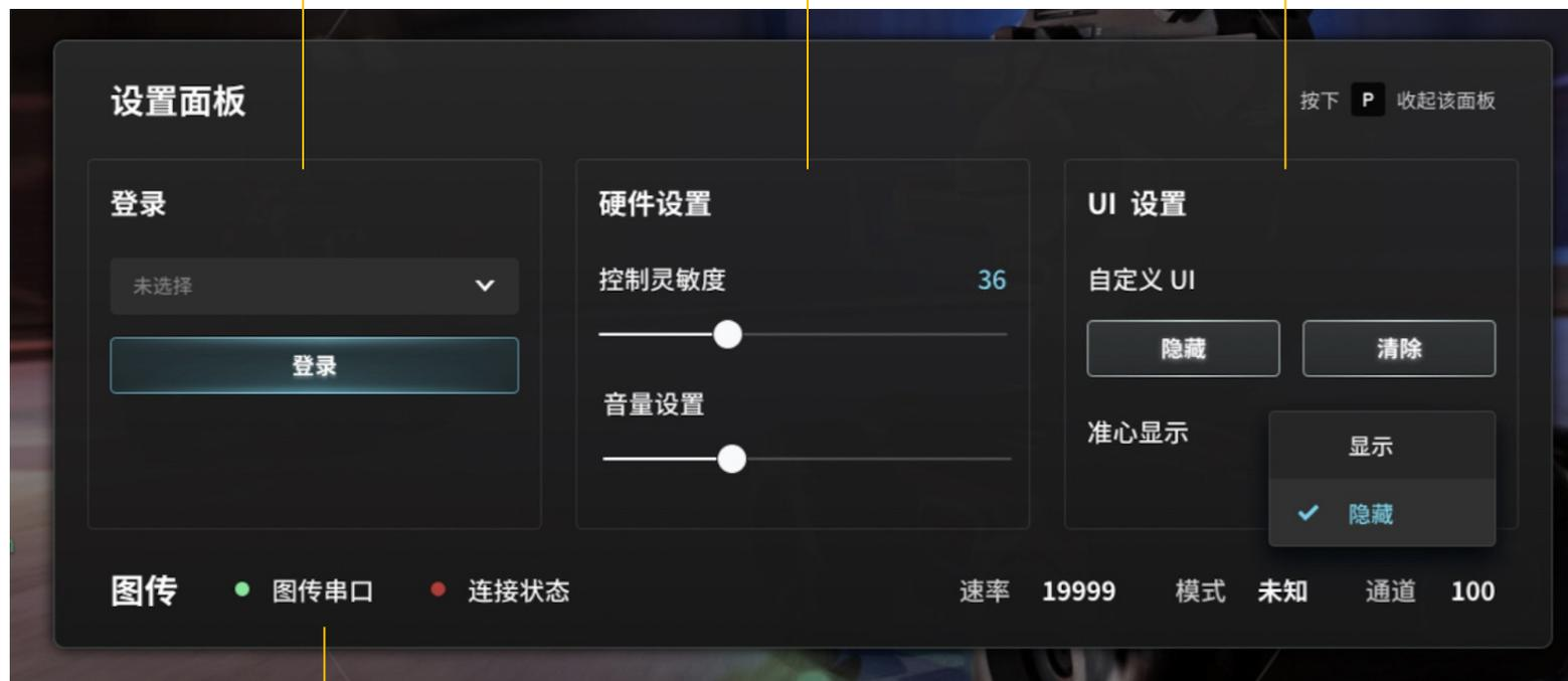
【图传】显示图传的串口和连接状态、速率、模式、通道
